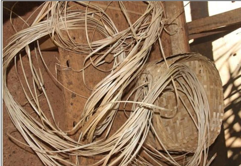
Figura 44: Fibra de urubamba já desbastada e preparada para o trançado. Foto: Hélio Caldas
