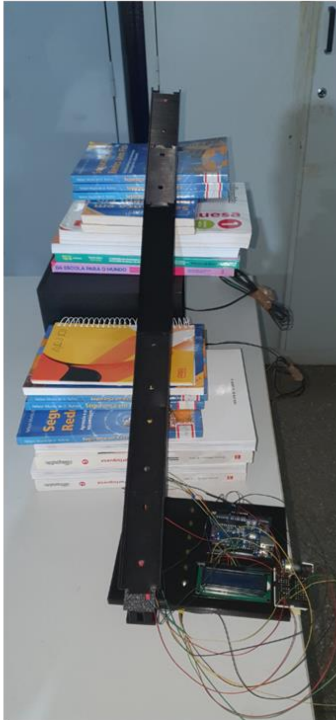
Figura 24 – Montagem do Kit Experimental de Cinemática.
