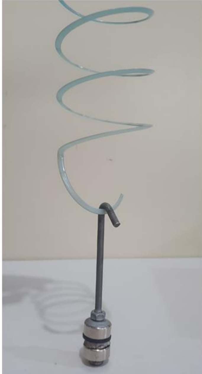
Figura 28 – Conjunto mola-ímã produzido para o sismógrafo eletromagnético.
