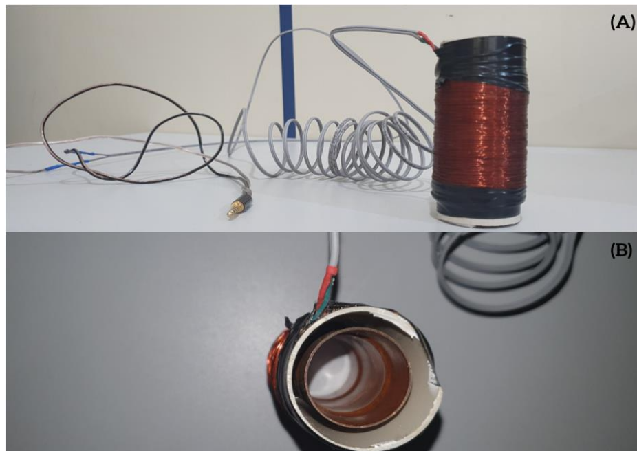
Figura 27 – (A) Vista frontal e (B) vista superior da bobina elaborada durante o projeto.
